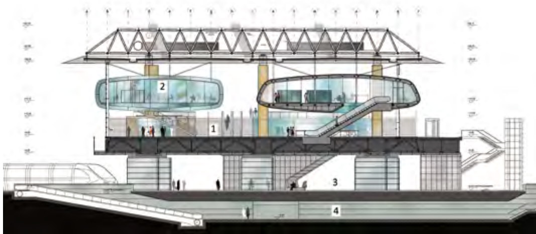
Fig. 2 - Sezione tipica della stazione TAV di Roma Tiburtina: 1) galleria-ponte; 2) volumi sospesi multi-funzionali; 3) livello banchine ferroviarie; 4) piazza ipogea (atrio Nomentano)
