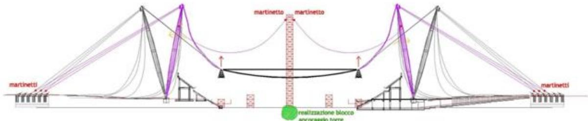
**Fig. 6:** Collegamento stralli esterni, rotazione interna e sollevamento strutture di copertura
