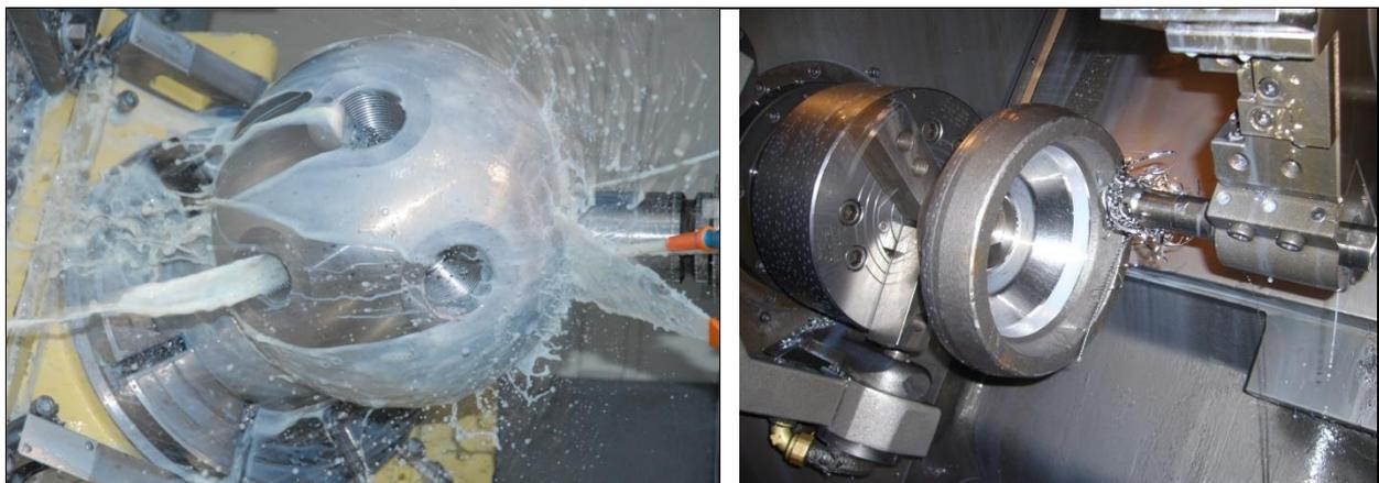
**Fig. 8:** Produzione con macchine utensili automatiche dei nodi della struttura reticolare spaziale
