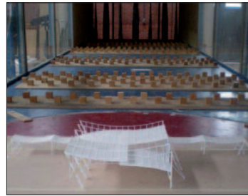
Figura 11: Modello in galleria del vento e grafico con i coefficienti di pressione di progetto
